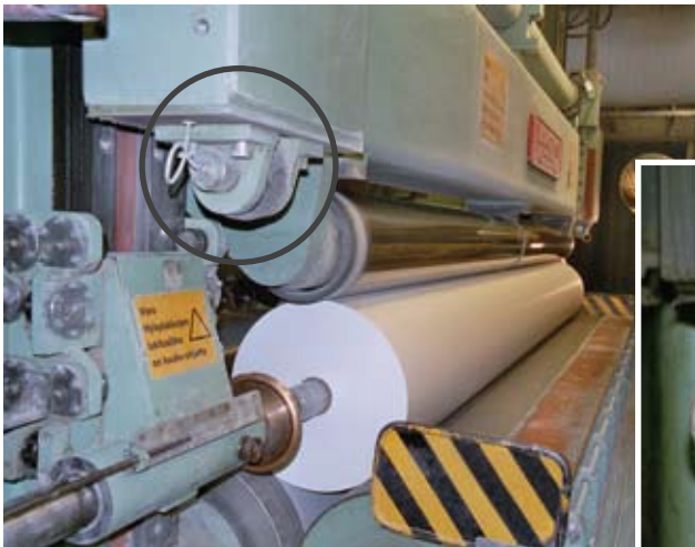
安装在压纸辊的 KISD 测力传感器
